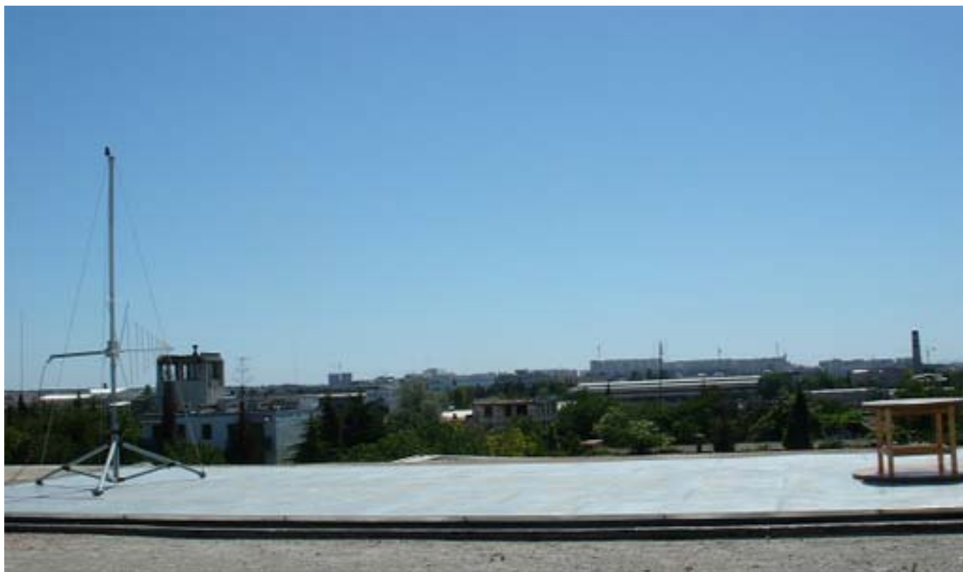
Фото 4. Открытая измерительная площадка на крыше лабораторного корпуса 33 Испытательного центра «Омега»
