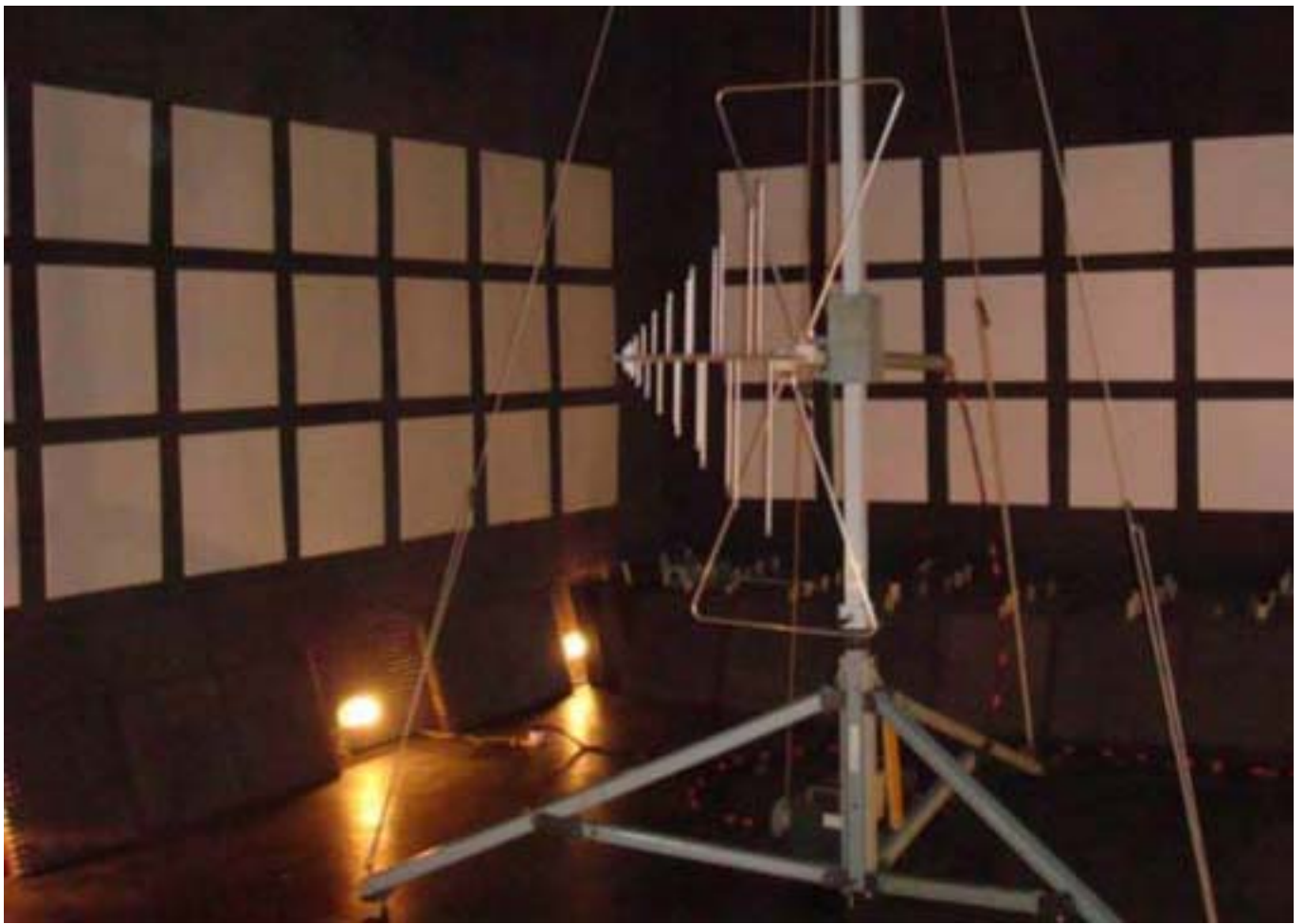
Фото 5. Полубезэховая экранированная камера с дистанционно-управляемым поворотным столом и антенным устройством
