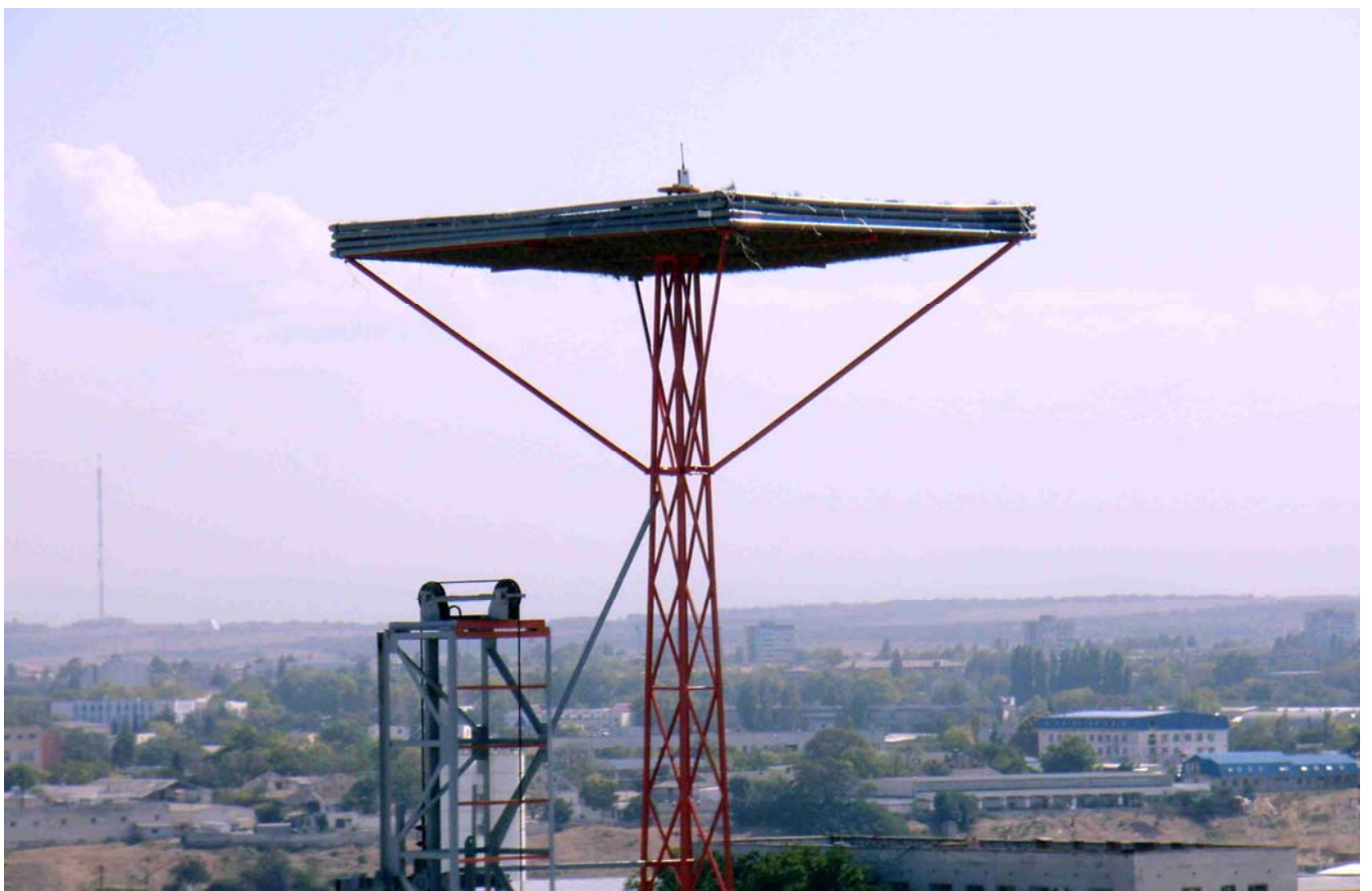
Фото 8. Рабочее место натуральных испытаний спутниковых аварийных радиобуев.
