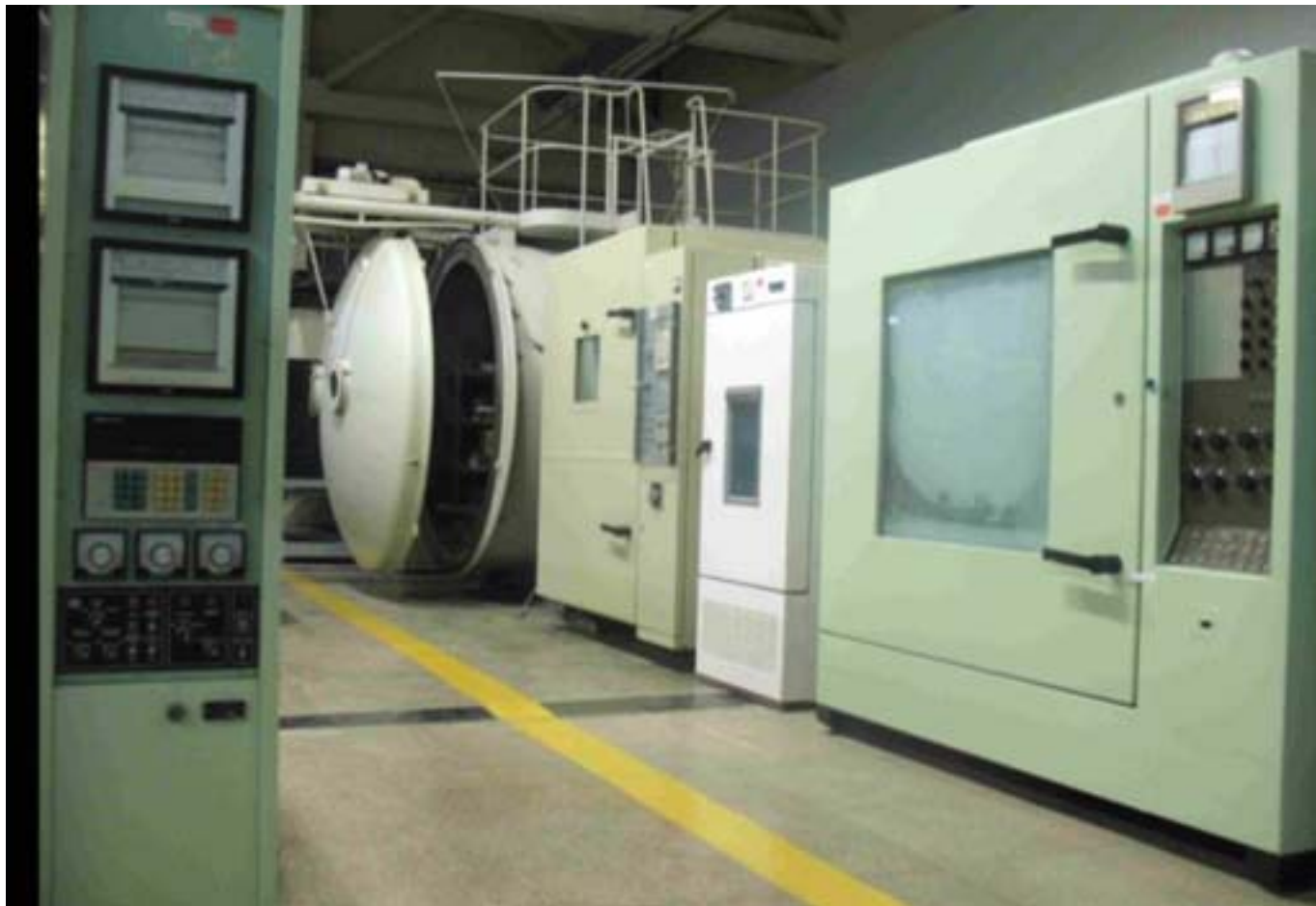
Фото 3. Рабочее место для климатических испытаний крупногабаритных образцов морского радиооборудования.
