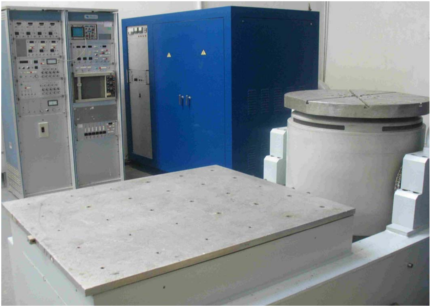
Фото 7. Рабочее место механических испытаний на прочность и устойчивость к вибрационным воздействиям.
